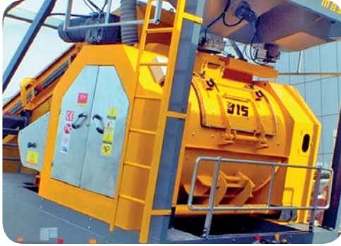
KOMPLE KAPLANMIŞ KOMPAKT GÖVDE, AÇILIR ÇİMENTO GİRİŞİ COMPACT FRAME, OPENABLE CEMENT INLET.
